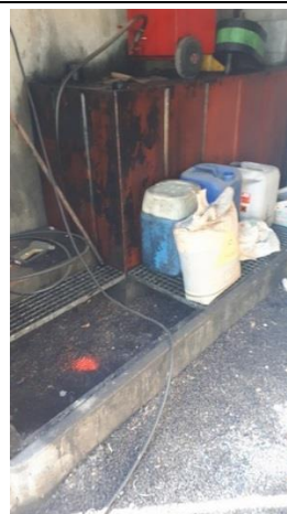
Photographie 10 : Aire de stockage d'huiles usées souillée
